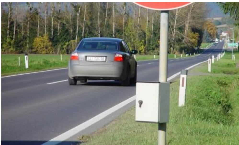
Slika 5.1 – Položaj uređaja Sierzega SR4 prilikom merenja
